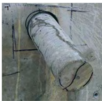
Foto 1) Campionature di valutazione con carotaggi dalla matrice in calcestruzzo delle strutture interrate sotto falda marina del Terminal 3 dell'aeroporto di Singapore Foto 2) Presenza di cristalli di differente forma e dimensione lungo una fessurazione: essi sigillano completamente la crepa (cristalli C-S-H, Silicato di Calcio Idrato) Foto 3) Ingrandimento "BEI" (backscattered electron image), mostra la crescita cristallina all'interno di una microfessurazione Foto 4) Particolare ulteriormente ingrandito della "BEI" mostra le tipologie di cristalli: sottili e oblungi, fini ed aghiformi.
